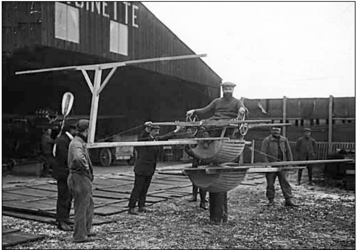
Le tonneau Antoinette, premier simulateur de vol créé par Léon Levavasseur (Châlon en Champagne, France, 1910)
